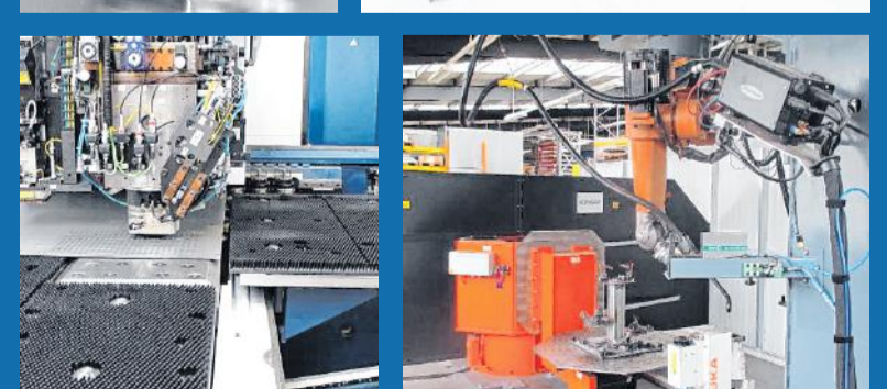
Bilder oben: Zwei Beispiele für Produkte, die von Weber hergestellt werden: Ofengehäuse für Laborgeräte (links) und Abluftkanäle (rechts). Bilder unten: Zum Maschinenpark gehören unter anderem eine Stanz-Laser-Kombimaschine (links) und Schweißroboter (rechts).
